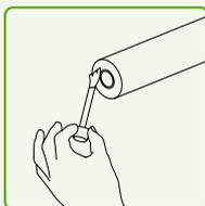
※塗布を怠ると手すり棒内部に錆が発生し、破損する恐れがあります。
